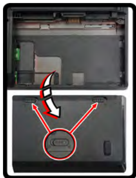
Figure 20 - Rimozione della batteria & Inserimento della carta USIM
