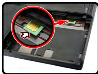
Figure 20 - Rimozione della batteria & Inserimento della carta USIM
